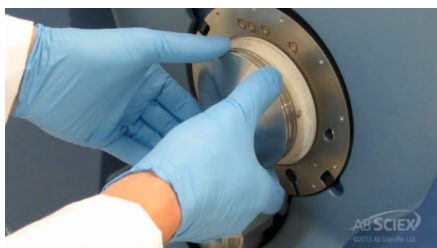
図 21.カーテンプレートの取り付け
