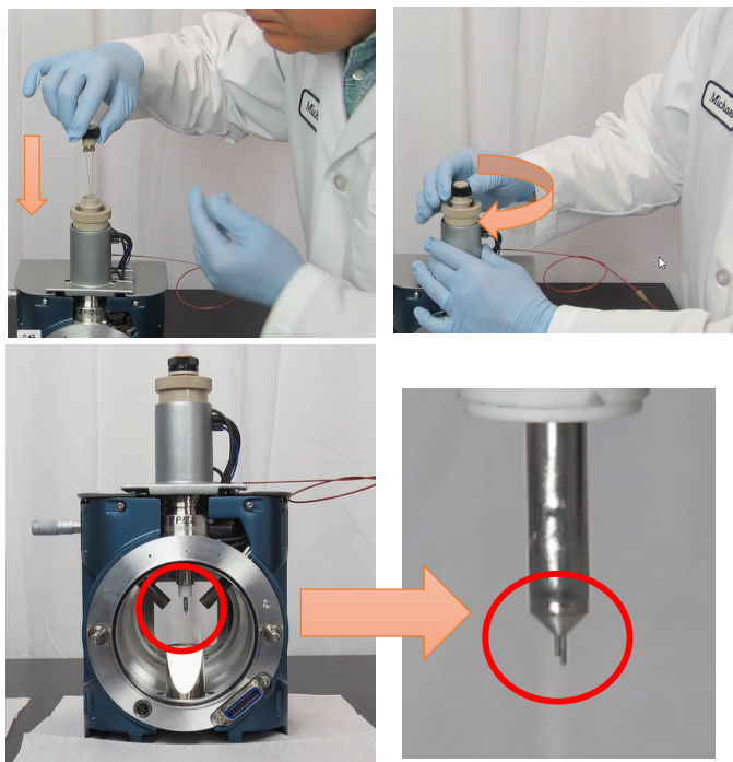
図 25.エレクトロードの取り付け
