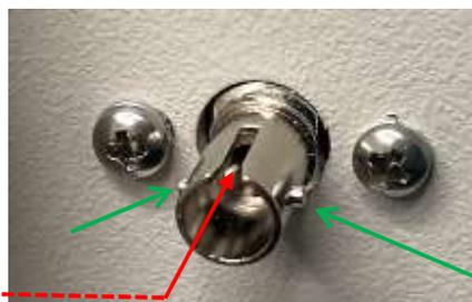
(差込む時に、この突起がディテクタ接続部のスリットに入ります。両側の開口部は接続部**左右の突起**と組み合います)
