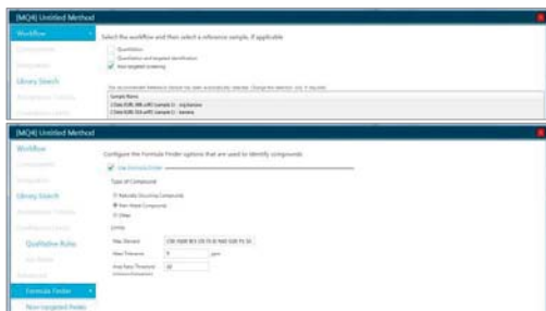
図3. ノンターゲットピークファインディングアルゴリズムを使ってXICを抽出し、コントロールとサンプルのXICを比較することで、マトリクスのシグナルと汚染物質に関連するシグナルを識別します。MSおよびMS/MSの情報から得られた候補組成をもとに、MS/MSを用いたライブラリサーチ、ChemSpiderサーチを自動的に実施します。ChemSpiderが導き出した構造とHR-MS/MSスペクトルが自動的に比較され、汚染物質の構造を推定します。
