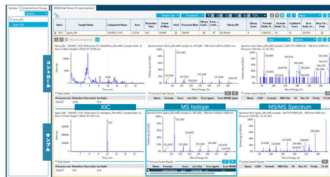
Figure 6. 2サンプル間の差分解析後の差分ピーク(推定:フェノキサプロップ)の、XIC、MSスペクトル、及びMS/MSスペクトル
